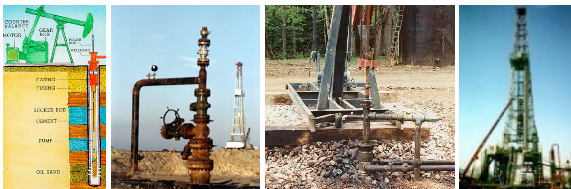
FIG. 7: Pozzi di petrolio in varie parti del mondo. A sinistra una schematizzazione del processo di estrazione. L'ultima immagine è il pozzo uno di Cerro Falcone nei pressi del centro oli di Viggiano, in Basilicata.
